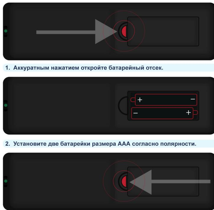
3. Плавным движением закройте батарейный отсек.
